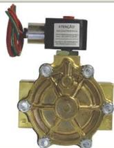
É um dispositivo eletromecânico usado para controlar o fluxo de combustível. A ferramenta é controlada pela corrente elétrica, que passa por uma bobina. Quando a bobina é energizada, um campo magnético é criado, fazendo com que um êmbolo dentro dela se mova, interrompendo o fluxo.
